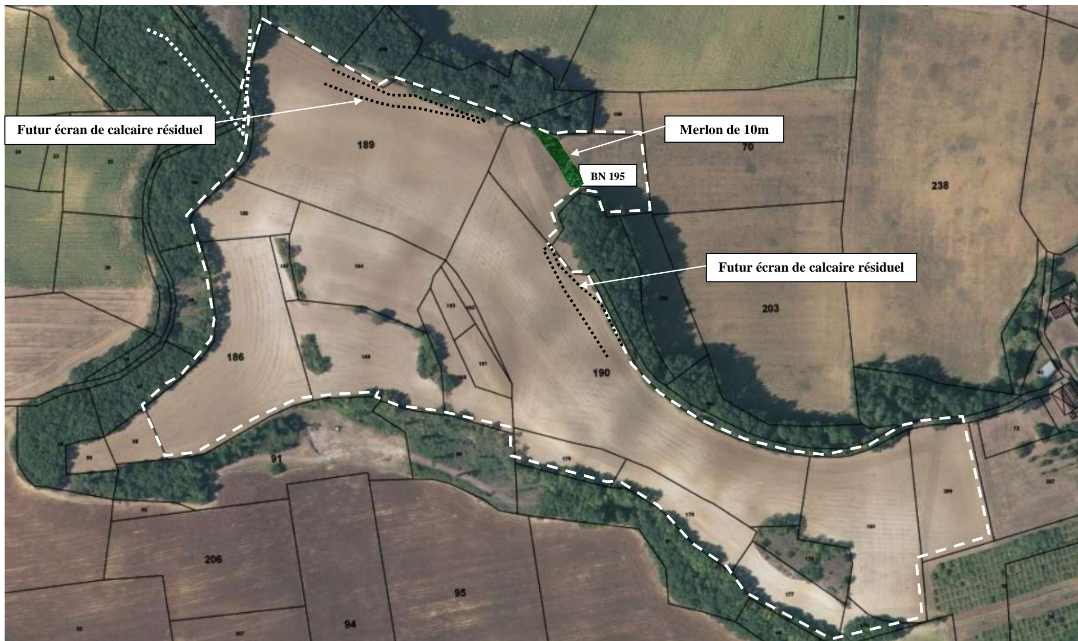
Figure 24 : Mise en place d'un merlon haut de 10 m au niveau de la trouée dans la ceinture boisée
